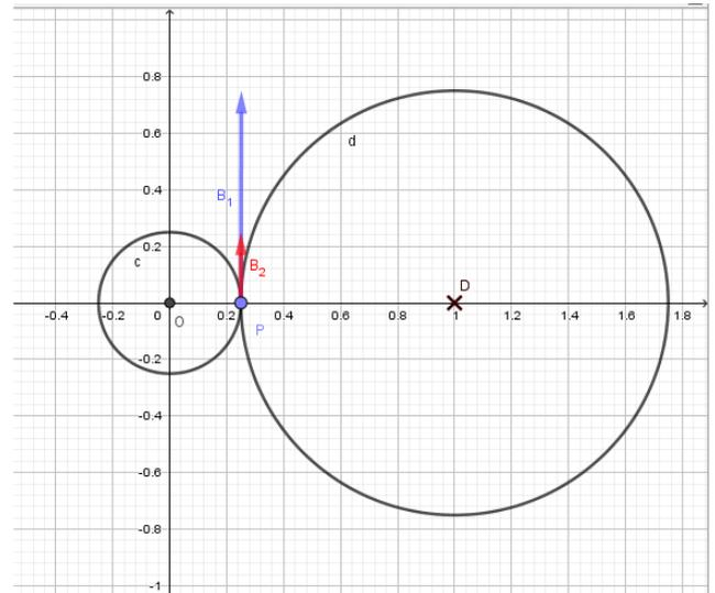
Rispetto al sistema di riferimento dato, in un punto P dell'asse x, con  $0 < x < 1$ , i vettori campo magnetico  $\vec{B}_1$  e  $\vec{B}_2$  risultano paralleli all'asse y e orientati nel suo verso positivo. Di conseguenza il vettore campo magnetico  $\vec{B} = \vec{B}_1 + \vec{B}_2$  ha la loro stessa direzione, il loro stesso verso e intensità uguale alla somma delle intensità. Per la legge di Biot-Savart:
