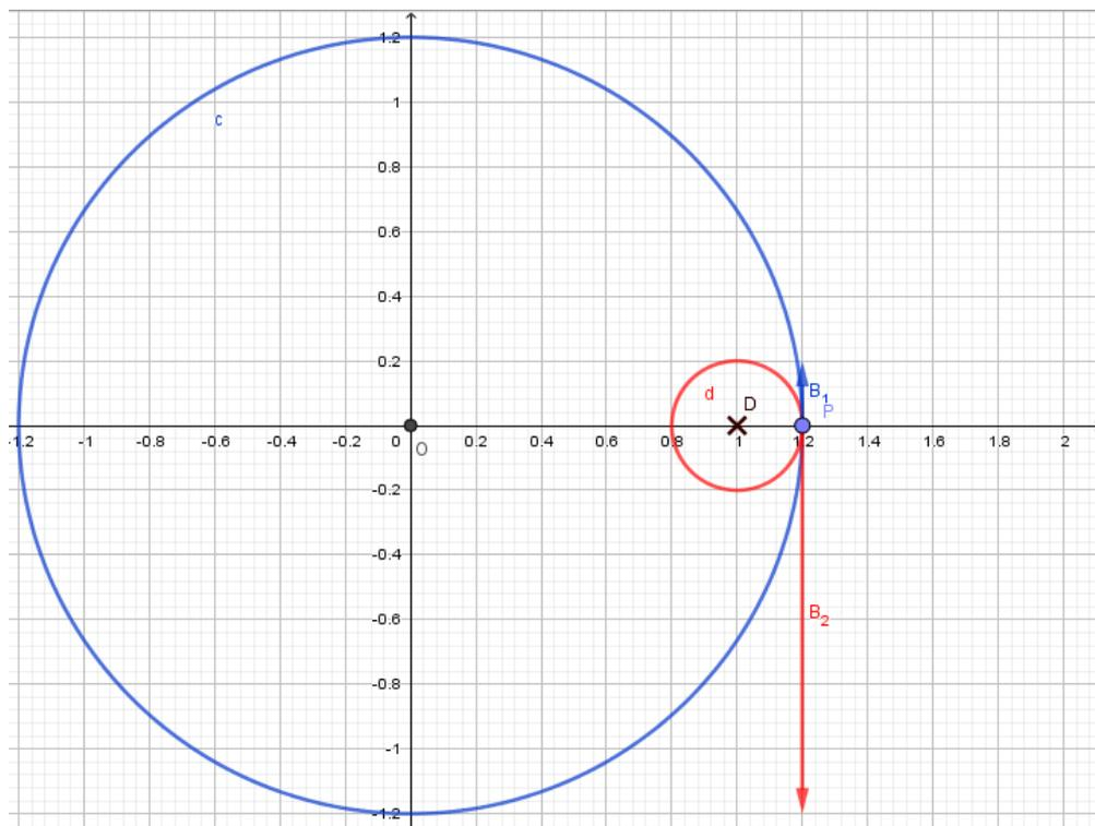
l'intensità di  $\vec{B}_1$  è minore dell'intensità di  $\vec{B}_2$ , perché P è più vicino a D.
